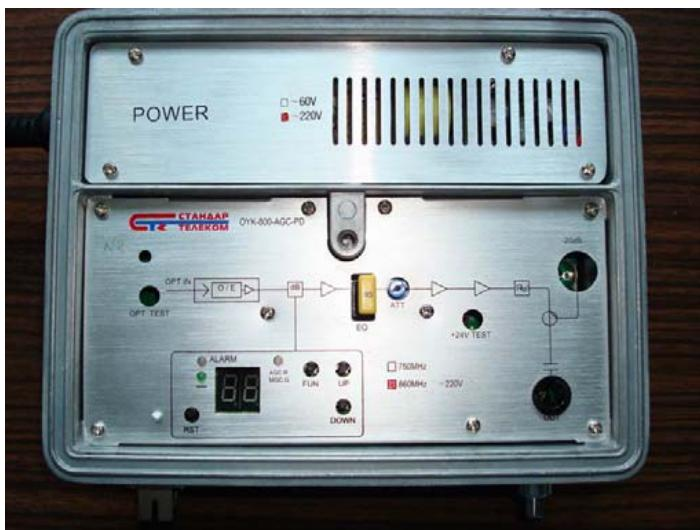
Компанией «Стандар Телеком» разработан оптический приемник ОУК-800AGC-PD для сетей кабельного телевидения.
