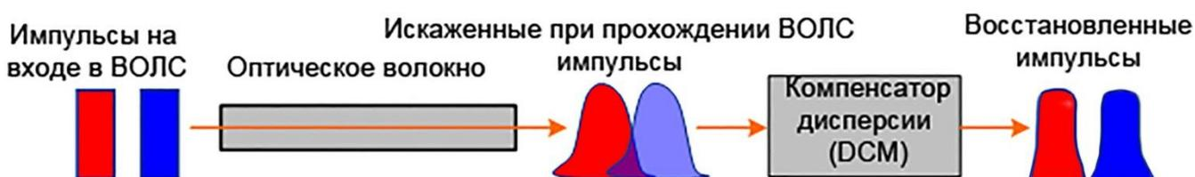
ООО «Стандар Телеком» разработал серию компенсаторов хроматической оптической дисперсии серии **КОД-G.652-C-Fxx**, адаптированных, в диапазоне длин волн 1525 -1565 нм, к стандартному одномодовому оптоволокну SMF-28 (ITU G. 652) и предназначенных для исправления формы оптических сигналов, искаженных под влиянием хроматической дисперсии.
