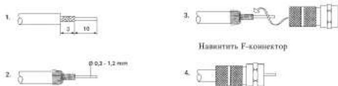
Рис.1. Установка F – коннектора
