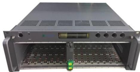
Особенность модуля заключается в том, что он состоит из четырех независимых приемников обратного канала объединенных единым управлением.
