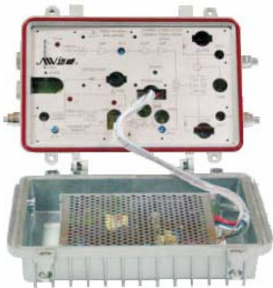
Оптический узел ОУК-800 рассчитан на круглосуточную работу в интервале температур  $-20^{\circ}\text{C} \dots +60^{\circ}\text{C}$ .
