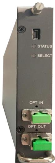
Модуль EDFA содержит микросхемы обнаружения оптического сигнала на входе и выходе, что позволяет автоматически подстраивать схему накачки лазера и поддерживать необходимый и постоянный уровень оптической мощности на выходе.
