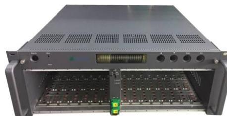
Параметры устройства можно контролировать либо по встроенному LED дисплею платформы или удаленно - через Ethernet, по протоколам SNMP и/или HTTP, с помощью WEB-интерфейса.
